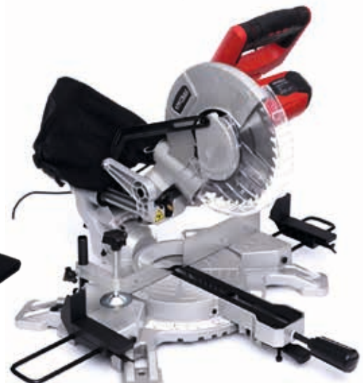
Lenķzāģis ar lāzeri KD3012 jauda: 2.5kW, zāģa diametrs: 210 mm
